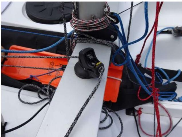
Dies ist die Klemme für den Vorsegelschlauch.
