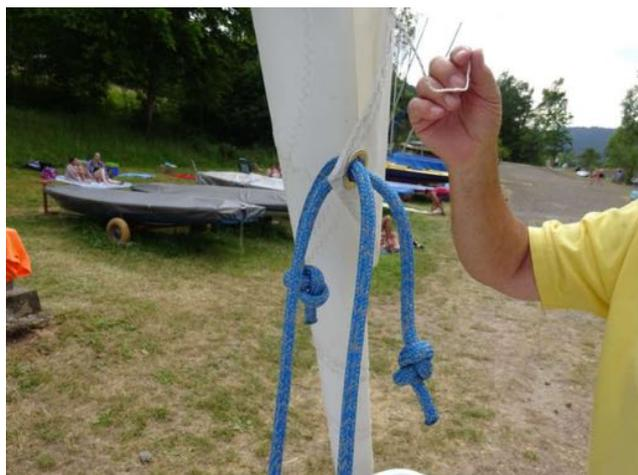
Schot an Fock anschlagen (zwei mal gegenläufig) und mit 8-Knoten sichern
